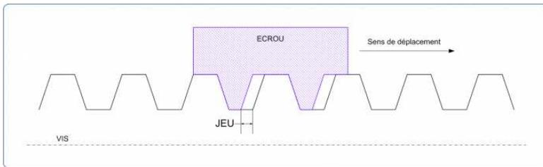
Jeu dans la liaison : une vis classique avec un écrou classique présente toujours du jeu ; il est nécessaire pour le fonctionnement sinon tout est bloqué. Le problème de ce jeu, dans le cas des transmissions, c'est qu'à l'inversion du sens de rotation de la vis, l'écrou ne se déplace pas (le temps de « rattraper » le jeu).
