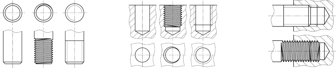
**Cotation :** sur les plans, le symbole «  $\varnothing$  » qui est réservé aux cylindres lisses.
