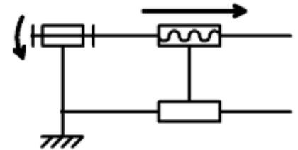
Schéma cinématique d'une transmission de puissance par système « Vis/écrou »
